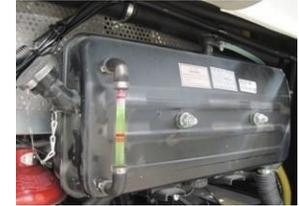
(2) Substitua o líquido de arrefecimento a cada 120 mil km ou 24 meses utilizando 60% etileno glicol e 40% água deionizada.
