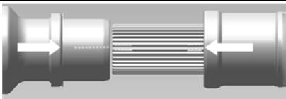
(2) Os componentes do eixo cardã: luva do eixo, manga estriada e garfo do flange do eixo, devem estar em bom estado.
