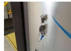
3. Mude o interruptor de baixa tensão de “ON” para “OFF”, e feche a tampa do compartimento.
