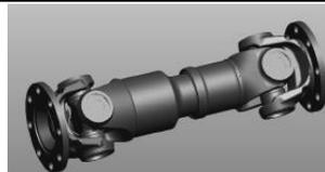
(3) Inspeccione a folga entre a junta universal. Substitua a junta universal ou o conjunto de roletes tipo copo, e agulhas, caso estejam danificados.
